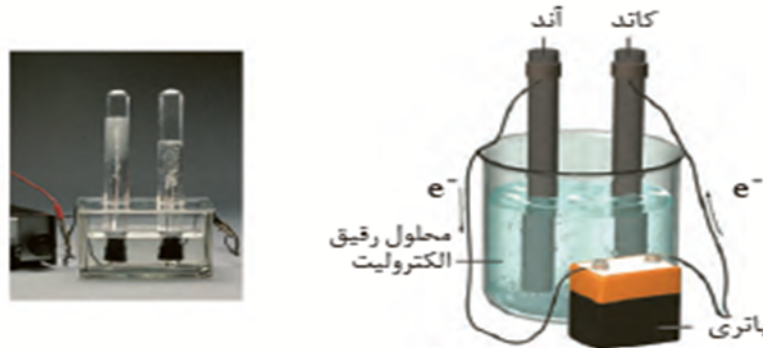
شکل ۱۱- تجزیه آب به گازهای هیدروژن و اکسیژن با مصرف انرژی الکتریکی
